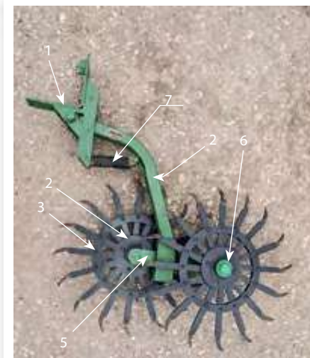
Рис. 1. Секция рабочих органов мотыги МРН-6: 1 — кронштейн; 2 — стойка; 3 — ступица; 4 — диск ротационный игольчатый; 5 — коромысло с двумя осями; 6 — защитный колпачок; 7 — пружина стабилизирующая
