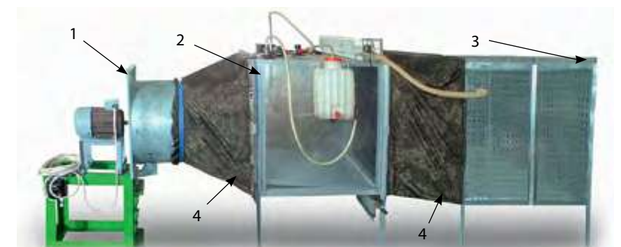
Рис. 2. Общий вид стендового оборудования для моделирования технологий распылителей штанговых опрыскивателей: 1 — модуль для создания воздушного потока с требуемыми характеристиками; 2 — узел для распыления жидкости и улавливания оседающих капель в поперечном и продольном направлении; 3 — модуль с отверстиями для снижения скорости воздушного потока и распределения мелкодисперсного аэрозоля; 4 — кожух соединительный
