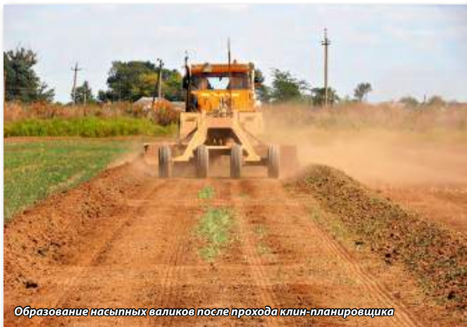
Рис. 1. Взаимосвязанная технологическая схема выравнивания чека клин-планировщиком и скрепером
