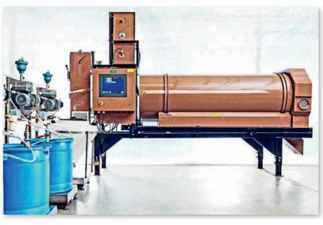
грузовика или автозагрузчик сеялок. Такие машины позволяют обрабатывать материал в нужном для высева количестве. Впрочем, существуют отдельные модификации подобных установок, например ПС-5Б «Фермер» производительностью 20 т/ч, приспособленные для одновременного протравливания
