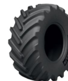
По запросу клиентов энергонасыщенный трактор может оснащаться шинами MICHELIN в первичной комплектации, которые существенно отличаются от шин в базовой комплектации. Так, например, грунтозацепы этих шин на 25–30% выше, чем у стандартных. Кроме того, шины MICHELIN 710/70 R38 MACHXBIB могут работать с пониженным давлением в 1–1,2 бар при скорости до 30 км/ч, что позволяет увеличить количество грунтозацепов в пятне контакта с почвой.
