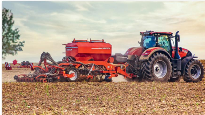
Производительность обеспечивается не только шириной захвата, что доказывает новая сеялка для технологии полосового возделывания StripTill — Focus 3 TD. Она реализует идею комбинирования трех операций в одной машине — обработки почвы, посева и внесения удобрений. Орудие успешно показало себя при посеве рапса, обеспечивая стабильное появление всходов в засушливых условиях.
