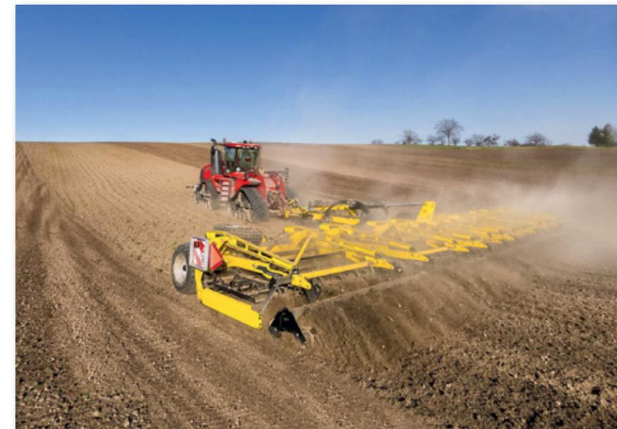
и базового шасси, при этом основные и вспомогательные колеса вынесены из зоны обработки почвы. Такое решение позволило произвести оптимальную расстановку лап по всей ширине захвата орудия. Рабочий орган культиватора — S-образная пружин-
