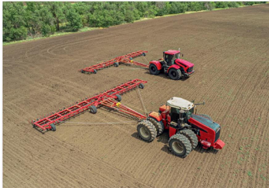
от 136 до 168 штук. Данные рабочие органы, функционирующие под отрицательным углом, позволяют избежать выноса влажных частиц почвы на поверхность. Подрессоривание каждой стойки позволяет увеличить рабочую скорость до 15 км/ч, что актуально весной, когда все необходимо делать быстрее. Ширина орудия в зависимости от модели составляет 14,2, 16,2 и 18,2 м, а в транспортном положении — 3 м. Рабочая глубина культиватора в зависимости от почвенных условий колеблется от 2 до 12 см.
