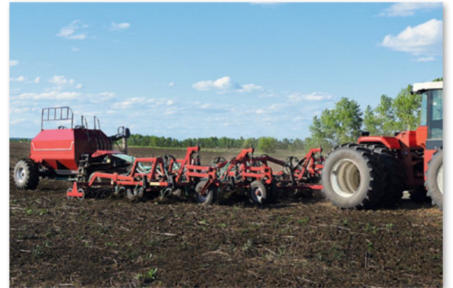
все большее распространение получает дисковая конструкция данного органа. При механическом типе материал высевается только за счет собственного веса, поэтому такая техника работает хорошо на выровненных пашнях без сорняков, но непригодна для полей, где применялась вспашка с оборотом
