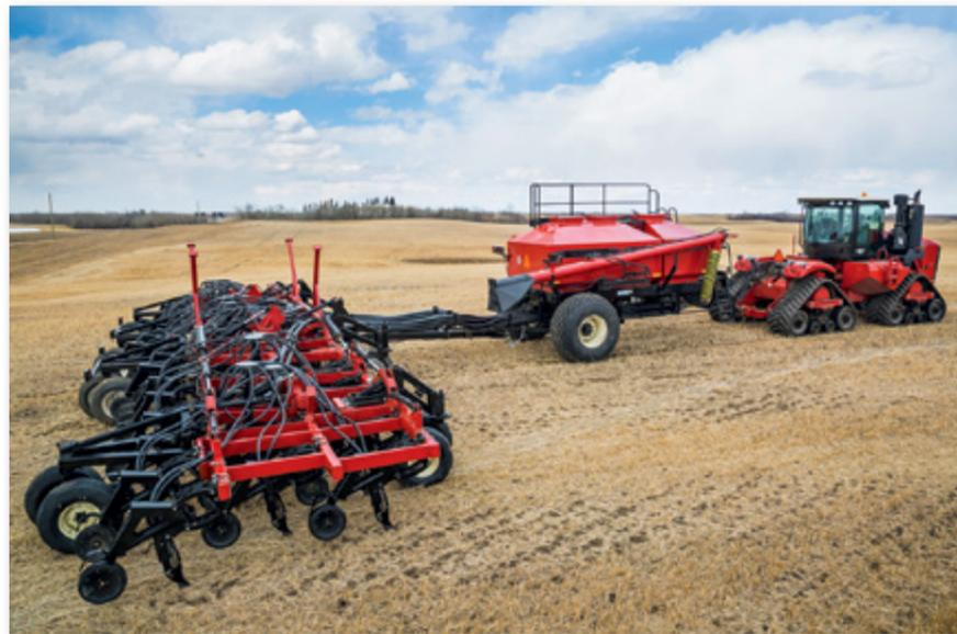
посев с одновременным удалением сорняков и внесением гранулированных либо жидких удобрений.
